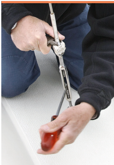
Der skal som regel blot en skruetrækker og en svensk-nøgle til at trimme riggen med. Spænd generelt så hårdt, at der er musik i vantene, når du ”spiller” på dem. Husk at slutte med splitter og tape.
