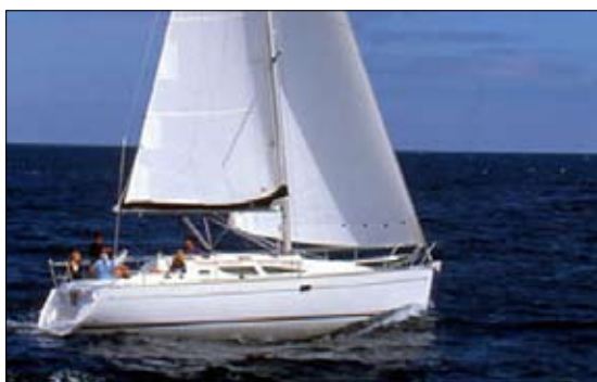
Jeanneau 35 findes i en cruiser-racer version, Sun Fast (øv), og en turbåds version, Sun Odyssey (ne). Bemærk fx kevlar sejlene på Sun Fast versionen. De holder en bedre facon i vinden og tåler større belastninger, hvilket giver den sidste halve knob, kapsejleren går efter.
