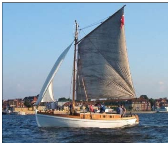
KDL Lodsåden (tv) er kravelbygget af eg på eg. Den fungerede som lods- og havnebåd i Holbæk i mere end et halvt århundrede.
